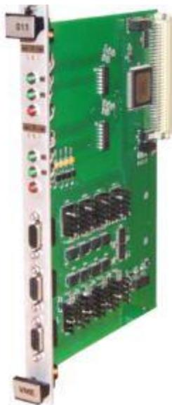
МУШД модуль управления шаговыми двигателями А011 конструктивно является модулем открытого типа 6U. Применяться в составе автоматизированных систем, построенных на основе аппаратуры VME и предназначен для управления двумя шаговыми двигателями типа ДШМ-16-8 или аналогичными, со следующими характеристиками:
