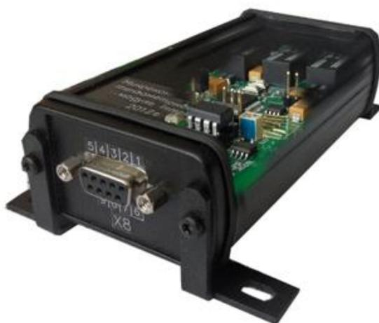
Микроконверторная тензометрическая аппаратура МКТА8/МКТА предназначена для измерения статических и низкочастотных сигналов от тензометрических датчиков, включенных по мостовой схеме, с последующей передачей цифровых данных по интерфейсу RS-485. Для размещения модулей МКТА применяются два вида корпусов. Первый вариант позволяет разместить до 8 модулей МКТА, второй вариант только один модуль.
